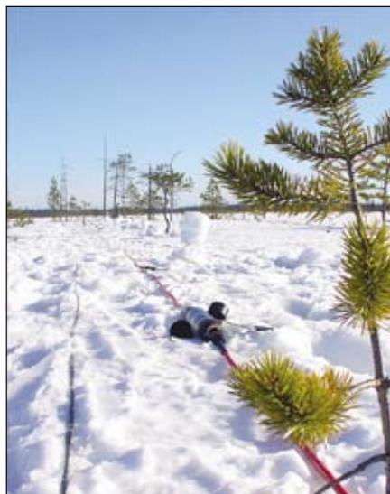
СЕЙСМОРАЗВЕДочНЫЕ РАБОТЫ С ТЕЛЕМЕТРИЧЕСКОЙ СТАНЦИЕЙ ТЕЛСС-1 В ЗИМНИЙ ПЕРИОД
