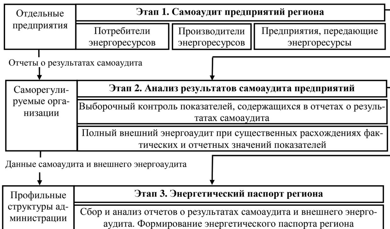
Рисунок 8 – Блок-схема предлагаемой процедуры энергоаудита региона
